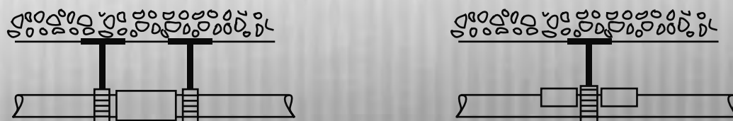
obr. 9: instalace pevného bodu
